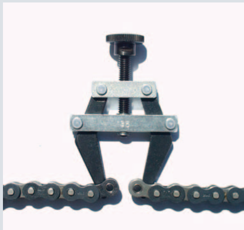
Kettenmontagespanner Praktischer Kettenmontagespanner um den Einbau einer Kette zu vereinfachen.
